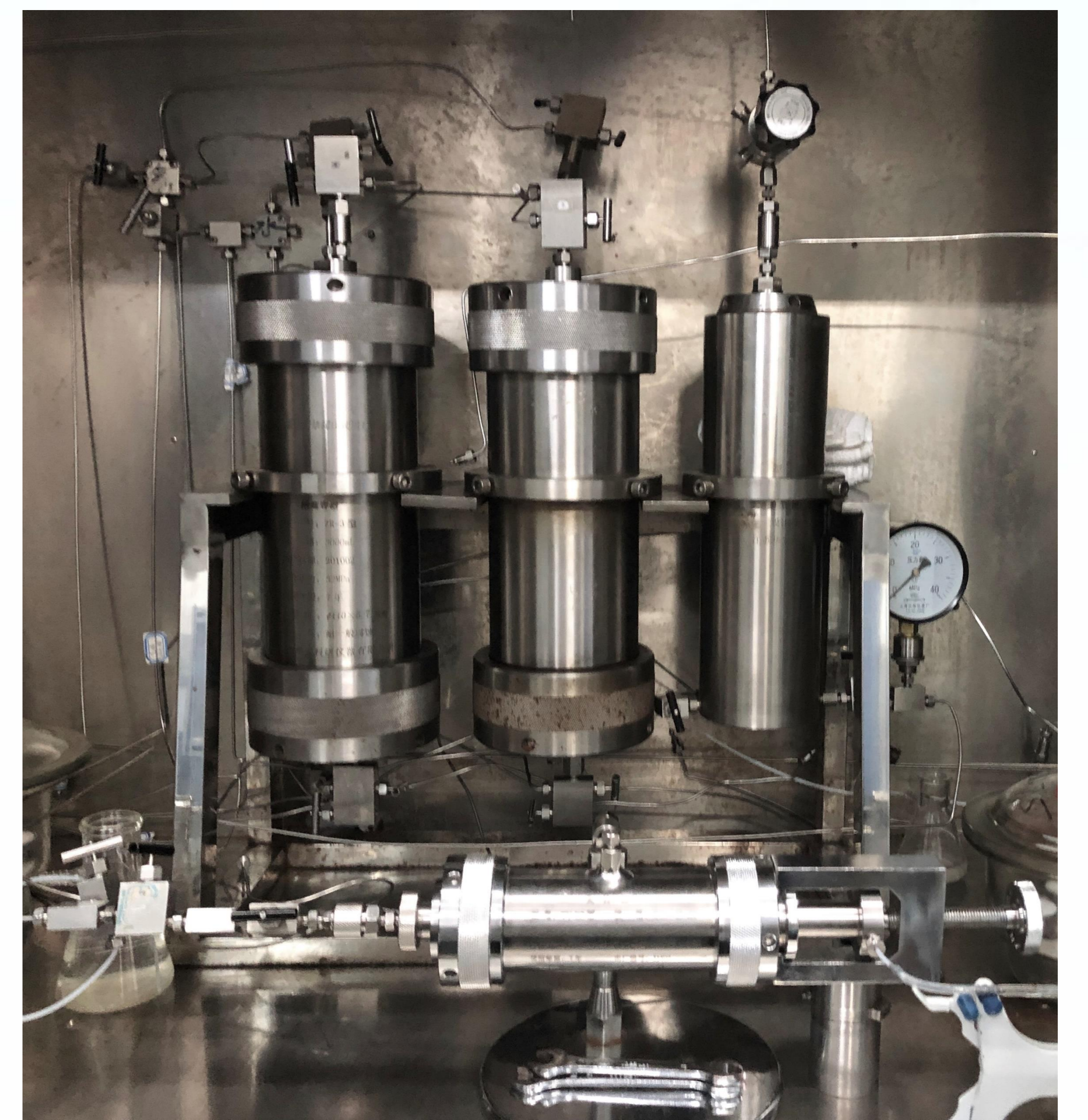
岩体渗流及突破压力实验仪器 [3-5]
